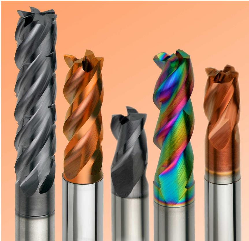
**Der Werkzeughersteller Nachreiner aus Balingen erweitert die erfolgreiche Superstar-VHM-Fräser-Serie. Von links: zum trochoidalen Hochgeschwindigkeitsfräsen; Bohr-Fräser zum Eintauchen und Rampen mit  $45^{\circ}$ ; als Kurzversion bzw. als Einwegfräser; zur Alu-Bearbeitung sowie für den Werkzeug- und Formenbau.**
